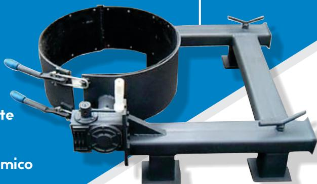
O dispositivo para transporte e giro de tambores até 200 litros proporciona mais segurança e agilidade durante a movimentação dentro de ambientes industriais. Sua estrutura é robusta e fabricada em aço carbono. Possui uma cinta reforçada de aço com grampo para travamento e regulação de diâmetro. Na parte interna utilizamos uma proteção emborrachada para evitar rasuras no tambor e proporcionar mais aderência.
